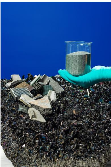
Mit dem innovativen RECOSiC-Verfahren leisten wir einen bedeutenden Beitrag zur sicheren und nachhaltigen Versorgung mit SiC, einem strategisch wichtigen Hochleistungswerkstoff. Durch das Recycling von Nebenprodukten aus dem energieintensiven Acheson-Prozess gelingt es, hochwertiges SiC nahezu vollständig aus Nebenfällen zu gewinnen - ohne den Einsatz neuer Primärrohstoffe.
