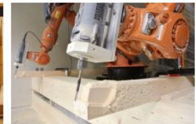
Computergesteuerte Holzbearbeitung, Foto: Robotics
