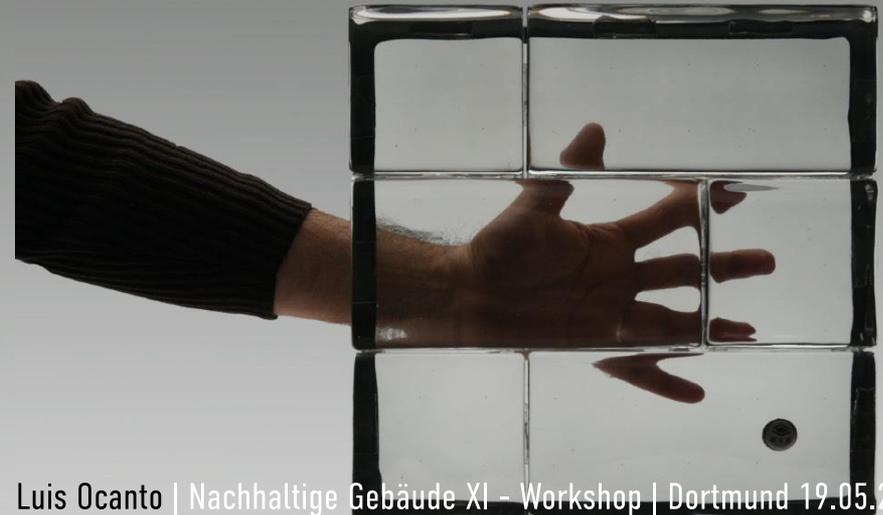
Die Grundidee dieses Forschungsvorhabens war es ein schichtweise modular aufgebautes Fassaden-System mit hervorragendem Wärmeschutz zu realisieren, bei dem die Hauptfunktionsebene Vakuumbglas mit der Funktion des Wärme- und Schallschutzes durch andere Funktions- und Gestaltungsschichten ergänzt wird.
