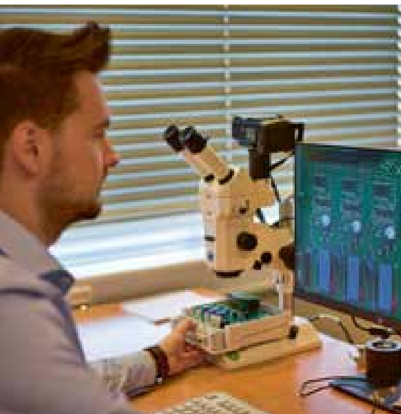
Prüfung der Platine eines Smart Meters im Verlauf des Qualifikationsverfahrens
