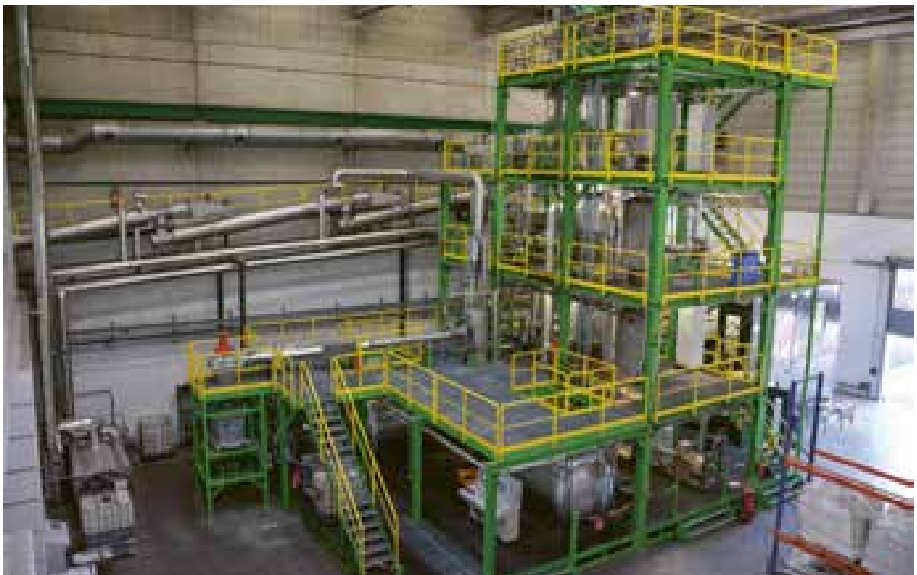
Pilotanlage im Entsorgungszentrum Ennigerloh (Kreis Warendorf) zum chemischen Recycling von Kunststoffabfällen
