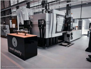
Smart Plastify revolutioniert die Kunststoffverarbeitung mit einer innenbeheizten Plastifizierschnecke. Durch geringere Abwärmeverluste und optimierte Wärmeübertragung ermöglicht die Technologie signifikante Energieeinsparungen beim Plastifizieren von Kunststoffgranulaten und bietet eine prozesssichere Verarbeitung von Kunststoffrezyklaten – ein wichtiger Beitrag für mehr Nachhaltigkeit und eine funktionierende Kreislaufwirtschaft.
